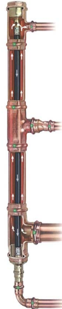
Funktionsprinzip der innenliegenden Zirkulation
