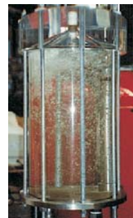
Bild 11: dynamische Vakuum-entgasung am 'servitec'-Versuchsstand
