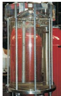
Bild 10: statische Vakuum-entgasung im „ruhenden Vakuum“
