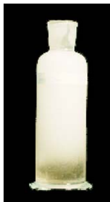
Bild 2: stickstoffübersättigtes, Heizungswasser nach der Probenahme
