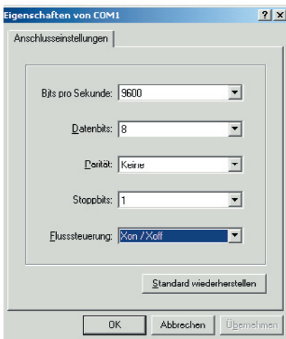
Abb 5.3: Einstellung im Hyper Terminal
