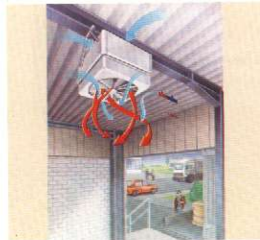
6. Deckenluftheizgerät mit spezieller Ausblasdüse
