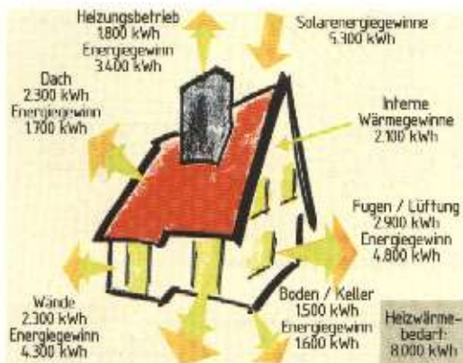
2. Wärmeverluste und Wärmegevinne eines Hauses
