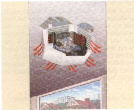
4. Aufbau eines Luftheizgerätes
