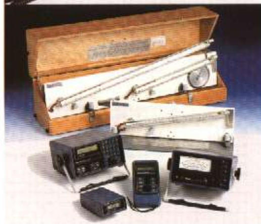
5. Messgeräte zum Messen des Kanaldruckes und der Luftgeschwindigkeit
