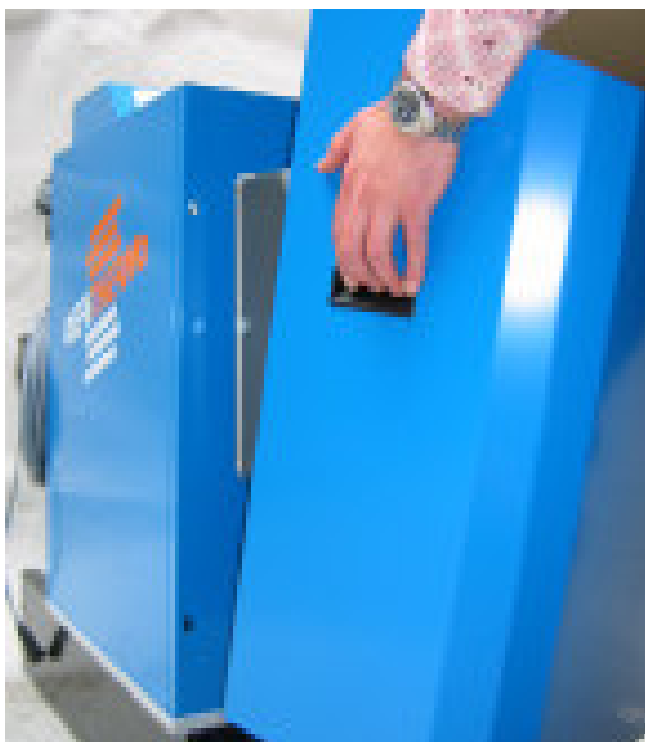
Bild 3-2: Abnehmen der optionalen Schallschutzhaube.
