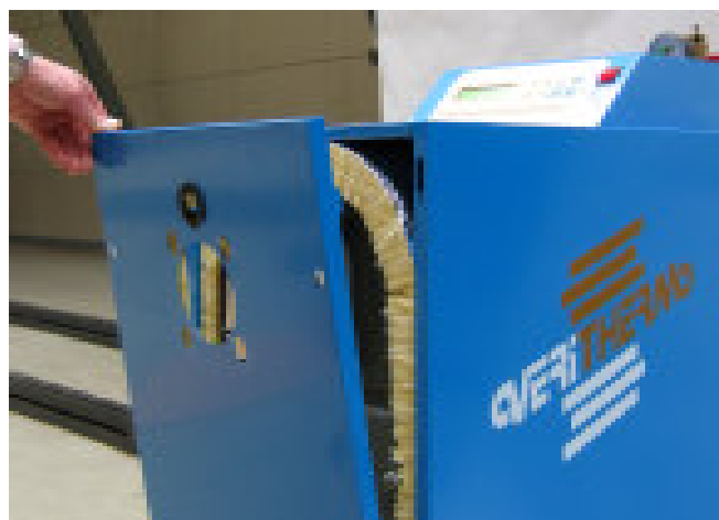
Bild 3-10: Vorderwandabdeckung aus der Bodenwanne heben und abnehmen
