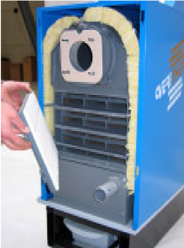
Bild 3-11: Kessel ohne Vorderwandabdeckung, mit abgenommener Revisionsklappe und frei liegendem Primärwärmetauscher.
