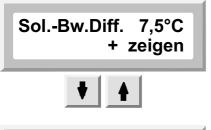
Hier wird die Temperaturdifferenz zwischen dem Solarpanel und dem entsprechenden Brauchwasserspeicher angezeigt ( Zusatzfühler - Brauchwasserfühler ). Mit der "+"-Taste wird dieser Wert auch in der Hauptanzeige dargestellt.
