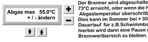
Der Brenner wird abgeschaltet, wenn die Kesseltemp. 73°C erreicht, oder wenn die hier angegebene maximale Abgastemperatur überschritten wird. Dies kann im Sommer bei > 30° Aussentemperatur und Dauerlauf für z.B.Schwimmbadheizung vorkommen, hierbei wird dann eine Pause eingelegt um ständig im
