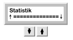
Durch Drücken der Pfeil-Tasten im Untermenü gelangt man zu Anzeigen, in denen verschiedene statistische Werte dargestellt sind. Diese lassen sich durch Betätigen der "+"-Taste auch in die Hauptanzeige übernehmen.
