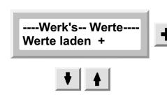
Sind evtl. Schaltpunkte oder Arbeitsweise des Systemes beinträchtigt, so kann dur laden der Werkswerte eine Grundeinstellung des Systemes erreicht werden. Alle Schaltpunkte und Angaben werden dabei auf Standardwerte gesetzt sodass ein fehlerfreier Betrieb gewährleistet wird.
