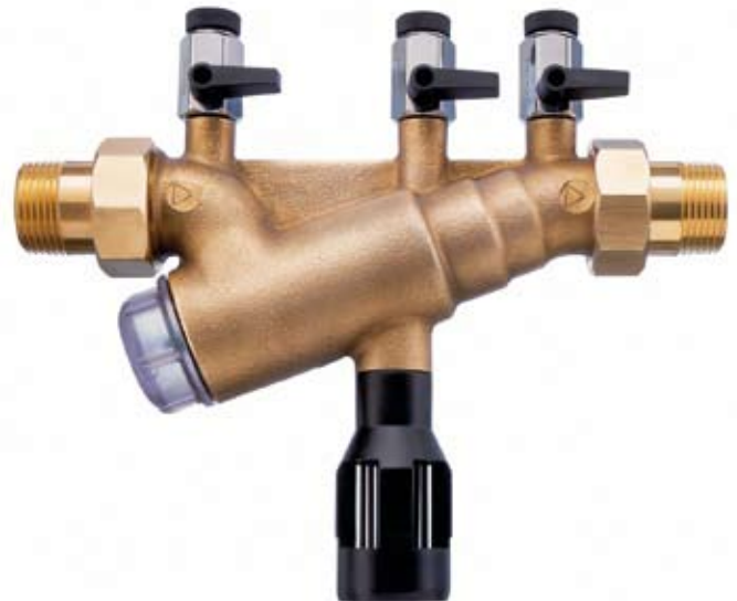
■ Bild 1: Mit dem Systemtrenner BA von SYR wird das Trinkwassernetz bis zur Flüssigkeitskategorie 4 abgesichert.
