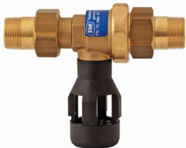
■ Bild 2: SYR Systemtrenner Typ CA: Diese für Deutschland neue Armatur wurde in die DIN EN 1717 aufgenommen und ist für Anwendungen bis zur Flüssigkeitskategorie 3 einsetzbar.
