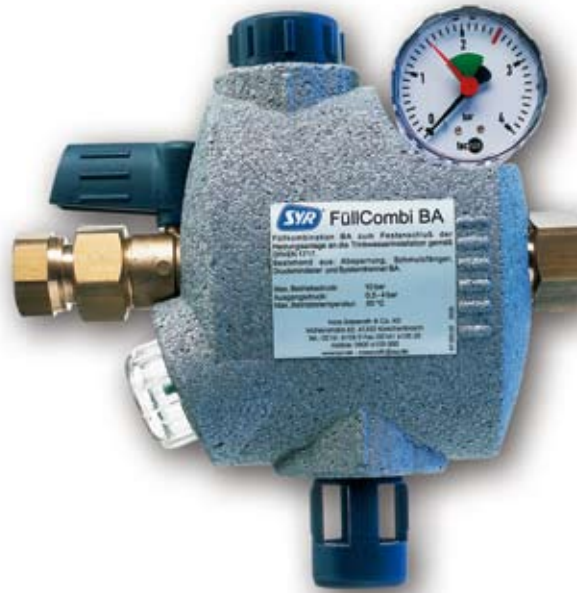
■ Bild 3: Die FüllCombi BA von SYR beinhaltet Kugelhahn, Druckminderer, Systemtrenner Typ BA und Ausgangsdruckmanometer. Hiermit ist z. B. eine normgerechte Absicherung des Trinkwassernetzes gegenüber einer Heizungsanlage gewährleistet.
