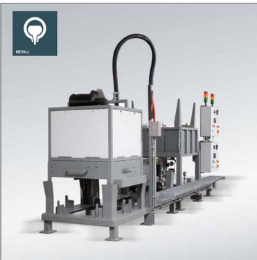
Beheizungsanlage zur Vorwärmung von Gußwerkzeugen
