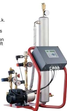
Das Anlagen- und Nachspeisewasser, ob in Heizungs-, Fernwärme- oder Kühlwassersystemen, wird im Vakuum entgast. Der Gasgehalt im Zirkulationswasser wird faktisch auf Null reduziert. Das heißt, keine „Luftprobleme“ mehr und Senkung des Korrosionsrisikos. Zusätzlich kann die Funktion von Druckausdehnungsgefäßen überwacht werden. 'servitec' ist besonders auch zur Nachrüstung in Problem-anlagen geeignet.
