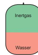
**geschlossene Membranausdehnungsgefäße mit Fremddruckerzeugung (dynamische Druckhaltung)**
