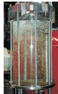
Bild 11: dynamische Vakuum-entgasung am 'servitec'-Versuchsstand
