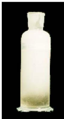
Bild 2: stickstoffübersättigtes, Heizungswasser nach der Probenahme
