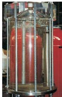
Bild 10: statische Vakuum-entgasung im „ruhenden Vakuum“
