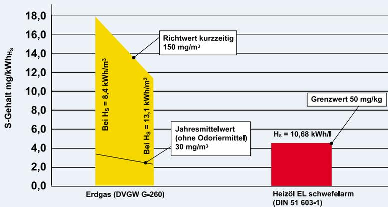
Zudem wird in der Norm für schwefelarmes Heizöl eine ausreichende Schmierfähigkeit für die Betriebssicherheit der Ölpumpen gefordert. Um diese Anforderung einzuhalten, wird bei Bedarf der Brennstoff mit so genannten Lubricity-Additiven (Schmierfähigkeitsverbesserer) additiviert.
