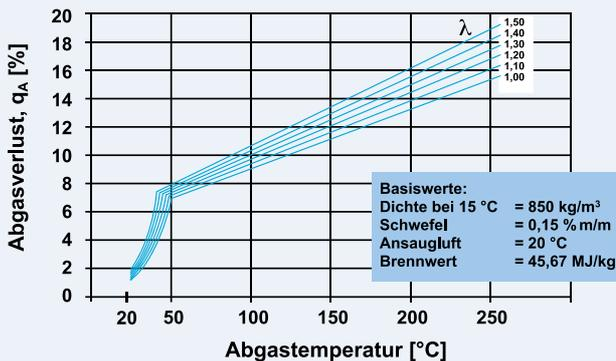
Diese Formeln sind für Brennwertanlagen nicht sinnvoll, da die zusätzlich nutzbare Kondensationswärme hierin nicht berücksichtigt wird. Daher sollte als Bezugsgröße für die Abgasverluste der gesamte Wärmehalt des zugeführten Brennstoffs, der Brennwert  $H_s$ , gewählt werden.
