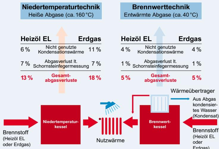
Werden dagegen Brennwertgeräte eingesetzt, kommt es beim Bezug auf den Heizwert zu Wirkungsgradangaben von über 100 %, weil zusätzlich ein Teil der Kondensationswärme nutzbar wird. Der Wirkungsgrad bei Gasgeräten ist daher scheinbar höher als bei Heizölgeräten.
