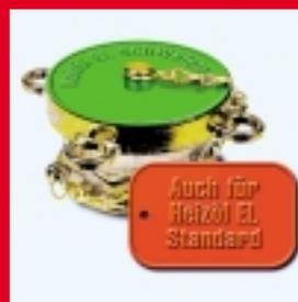
Die Kennzeichnung des Füllrohrverschlusses folgt der gleichen Farbgebung wie die der Aufkleber. Nur ein grüner Tankdeckel bedeutet, dass nur Heizöl EL schwefelarm eingefüllt werden darf. Ist am grünen Füllrohrverschluss noch ein roter Anhänger befestigt, so darf diese Anlage sowohl mit Heizöl EL Standard als auch mit Heizöl EL schwefelarm betrieben werden.
