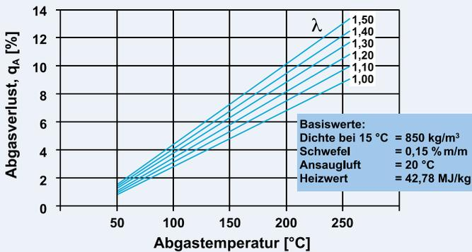
Zur Beschreibung der Energieausnutzung einer Heizungsanlage wird der Abgasverlust herangezogen. Hierbei handelt es sich um die Wärmemenge  $q_A$ , die den Wärmeerzeuger ungenutzt über die Abgasanlage verlässt. Der Abgasverlust wird in Prozent angegeben. Basis ist heute der Heizwert  $H_i$  des dem Wärmeerzeuger zugeführten Brennstoffs. Der Abgasverlust kann nach einer der folgenden Formeln näherungsweise berechnet werden:
