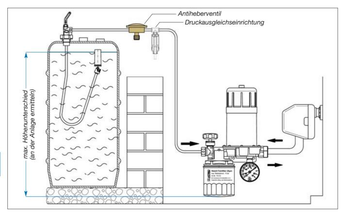
Durch die gesetzlichen Anforderungen im Gewässerschutz – §19 des Wasserhaushaltsgesetzes (WHG) – sind Heizöltankanlagen bzw. deren Rohrleitungen bedingt genehmigungspflichtig. Die Anlagen müssen derart ausgeführt sein, dass eine Verunreinigung der Gewässer ausgeschlossen ist.
