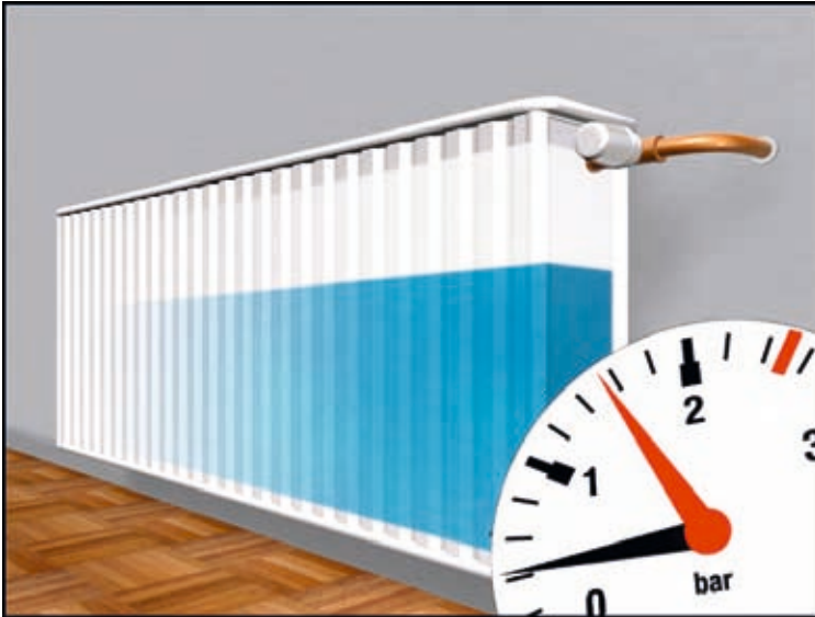
Bild 2: Absinken des Anlagendruckes begünstigt das Einsaugen von Luft an Heizungskörpern.
