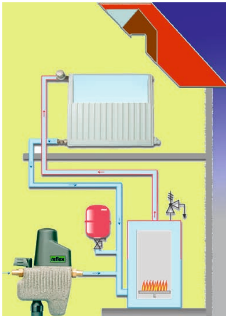
Bild 7: Einbau der „fillcontrol“ in der Heizungsanlage.
