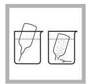
**5.** Eine AccuVac-Ampulle für gelösten Sauerstoff, kleiner Messbereich, mit Probe füllen. Die Spitze muss eingetaucht bleiben, während sich die AccuVac-Ampulle komplett füllt.
