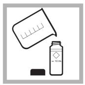
2. Mindestens 10 ml Probe in eine Küvette füllen (Blindwert).
