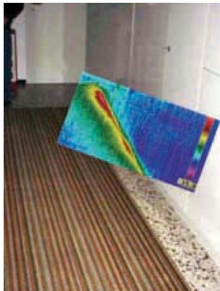
Leckage an einer im Fußboden verlegten Heizungsleitung
