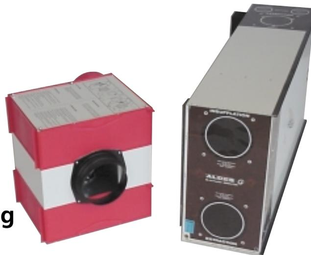
Die Besonderheiten des Gerätes: Das Lüftungsgerät VMP-H besteht aus einem zweistufigen separaten Doppelstromventilator sowie einem hocheffizienten Wärmetauscher. Die Ventilatoren (Zu- und Abluft) werden über einen Motor angetrieben. Aufgrund des zentralen Antriebes der Ventilatoren bietet das Gerät speziell beim gleichzeitigen Betrieb der Lüftungsanlage in Verbindung mit raumluftabhän-
