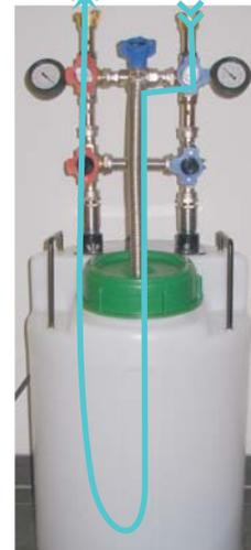
Filtersack am zweiten Zulauf. Leicht zu wechseln/reinigen
