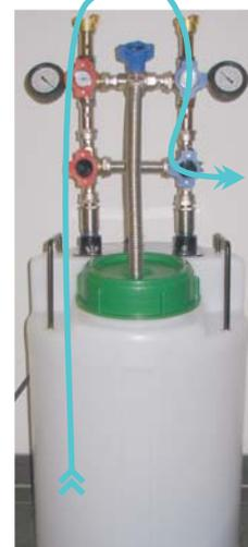
Wegpumpen in einen Zwischenbehälter (z.B. Inhibiertes Wasser)
