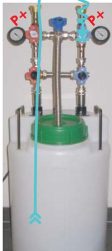
Rücklauf aus System sperren, Druck erhöht sich im System...
