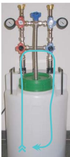
Zusätze, Inhibitoren, Frostschutz usw. gut durchmischen
