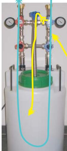
Bei laufendem Betrieb Nachfüllen oder Mittel beimischen
