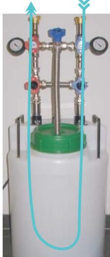
Gleiches Medium mehrmals durch die Anlage pumpen - zur Luftfreistellung
