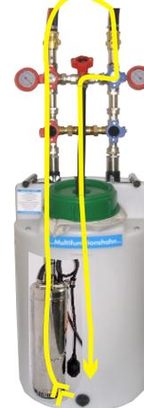
Gleiches Medium mehrmals durch die Anlage pumpen - zur Luftfreistellung.
