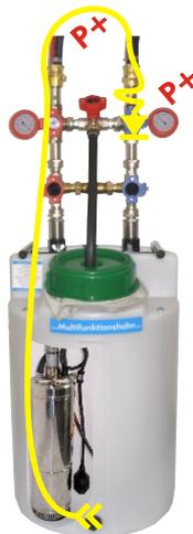
Kurzfristig den Rücklauf sperren und wieder öffnen. Die so erzeugten Druckschläge im System helfen Lufteinschlüsse ... los zu rütteln.
