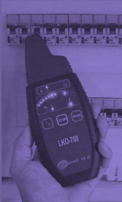
**Lokalisierung der Leitungen in Decken, Wänden und Fußböden**
