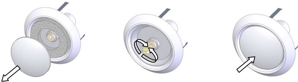
Einregulierung der Bedarfslüftung am AV 1
