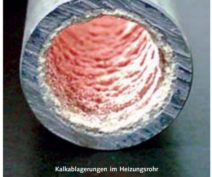
Kalkablagerungen im Heizungsrohr
