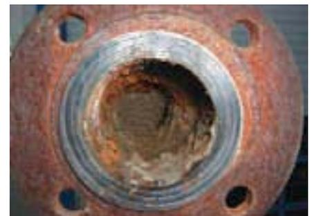
Schlamm in Stahlrohrleitung
