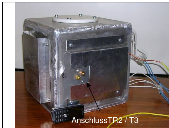
Abbildung 7.6: Speicher ohne Isolation, hinten
