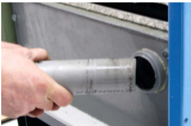
Bild 3-12: Zuluftrohr herausziehen, zur Demontage des Kunststoff-Wärmetauschers.
