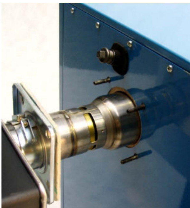
Bild 3-7: Brenner mit Glührohr vorsichtig aus der Brennkammer herausziehen.
