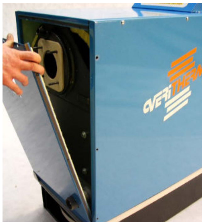
Bild 3-9: Vorderwandabdeckung aus der Bodenwanne heben und nach vorn abnehmen
