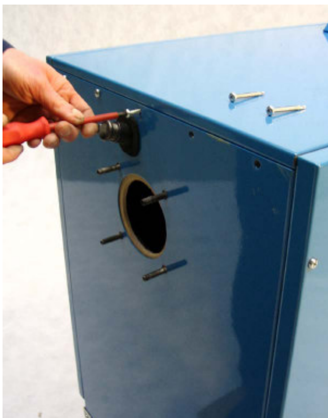
Bild 3-8: Abschrauben der Vorderwandabdeckung.
