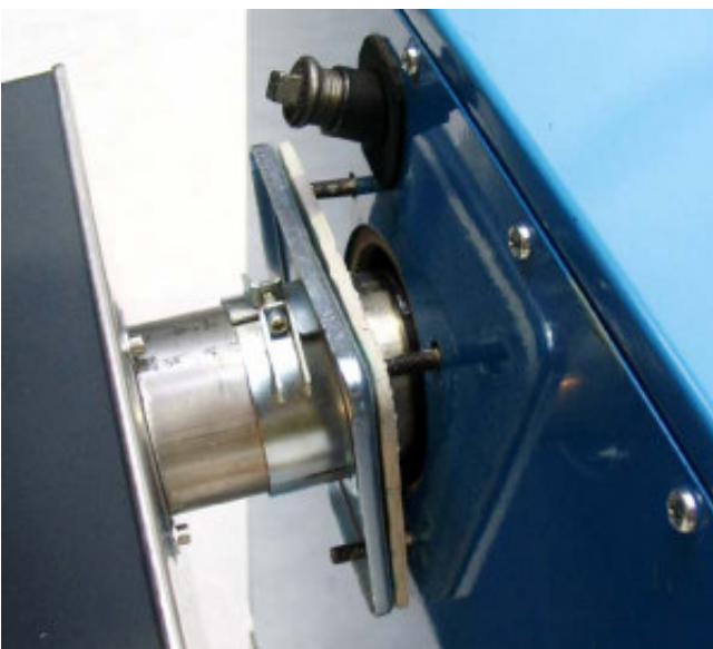
Bild 3-6: Zur Brennerdemontage die Skt.-Muttern am Brennerflansch lösen und abnehmen.
