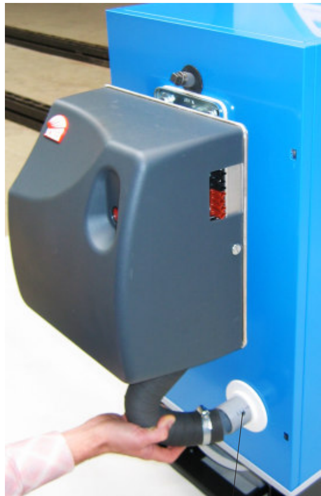
Messung der Verbrennungslufttemperatur
