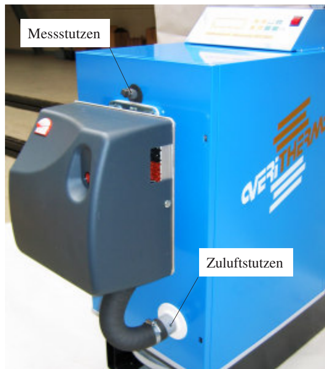
Bild 3-4: Messstutzen; CO 2 -, Unterdruck-Messungen usw. mit separatem Messgerät und zusätzlicher Messlanze in der Brennkammer. Unten: Messung der Verbrennungslufttemperatur am Zuluftstutzen.
