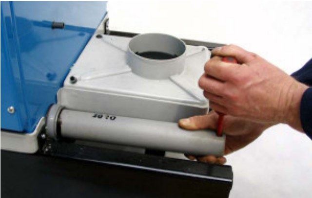
Bild 3-15: Demontage des hinteren Zuluftrohrs.
