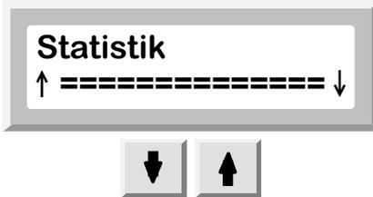
Durch Drücken der Pfeil-Tasten im Untermenü gelangt man zu Anzeigen, in denen verschiedene statistische Werte dargestellt sind. Diese lassen sich durch Betätigen der "+"-Taste auch in die Hauptanzeige übernehmen.
