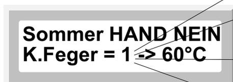
Schaltet der Brenner bei seiner Grenztempewratur ab ( 73° so wird die Kaminfegerfunktion damit automatisch gelöscht
