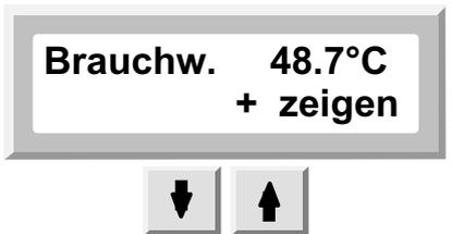
**+** Hier wird die Brauchwassertemperatur angezeigt, sodaß die Solarregelung entsprechend reagieren kann. Mit der "+"-Taste wird dieser Wert auch in der Hauptanzeige dargestellt.
