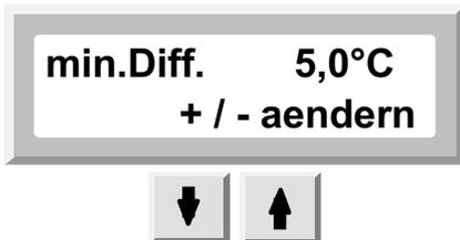
**+** Hier wird die Minimum Differenz festgelegt, bei der die Solarpumpe mit der Drehzahlregelung beginnt. Erst bei höherer Temperaturdifferenz beginnt die Solarpumpe zu arbeiten.
