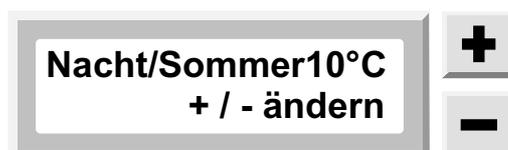
Hier wird die Aussentemperatur vorgegeben, bei der im Nachtbetrieb der SOMMER-BETRIEB beginnen soll. Steigt die Aussentemperatur (in der Absenkungszeit / Nachtbetrieb) über diesen Wert an, so wird der Mischer ständig ZU gesteuert und die Pumpe stillgesetzt. In der Anzeige erscheint (Sommerbetrieb HKr.)
