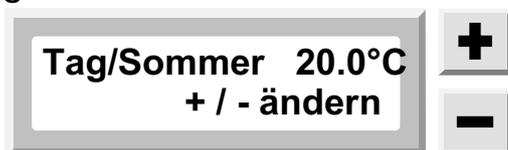
Hier wird die Aussentemperatur vorgegeben, bei der im Tagbetrieb der SOMMER-BETRIEB beginnen soll. Steigt die Aussentemperatur (bei nicht Absenkungszeit / Tagbetrieb) über diesen Wert an, so wird der Mischer ständig ZU gesteuert und die Pumpe stillgesetzt. In der Anzeige erscheint (Sommerbetrieb HKr.)
