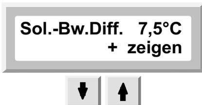
**+** Hier wird die Temperaturdifferenz zwischen dem Solarpanel und dem entsprechenden Brauchwasserspeicher angezeigt ( Zusatzfühler - Brauchwasserfühler ). Mit der "+"-Taste wird dieser Wert auch in der Hauptanzeige dargestellt.
