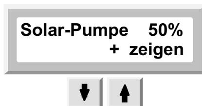
**+** Hier wird die Ansteuerung der Solarpumpe 0- 100% angezeigt, wobei die gesamte Drehzahlregelung über 5 K Differenz verteilt ist. Bei der Drehzahlregelung wird aber noch die Minimum Differenz abgezogen. Mit der "+"-Taste wird dieser Wert auch in der Hauptanzeige dargestellt.
