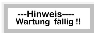
Die Steuerung aktiviert diese Meldung, wenn 1500 Brennerbetriebsstunden ohne Wartung aufgelaufen sind, oder wenn die Abgastemperatur aufgrund von Verschmutzung der Wärmetauscher über den Grenzwert angestiegen sind. Kann über Monteur-Menü Daten gelöscht werden.
