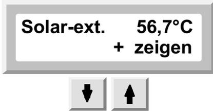
**+** Hier wird die Solartemperatur der Solarpanele angezeigt der spezielle Solarfühler (-20 bis 120°C) ist dabei an X 13 ( Zusatzfühler ) anzuschliessen. Mit der "+"-Taste wird dieser Wert auch in der Hauptanzeige dargestellt.
