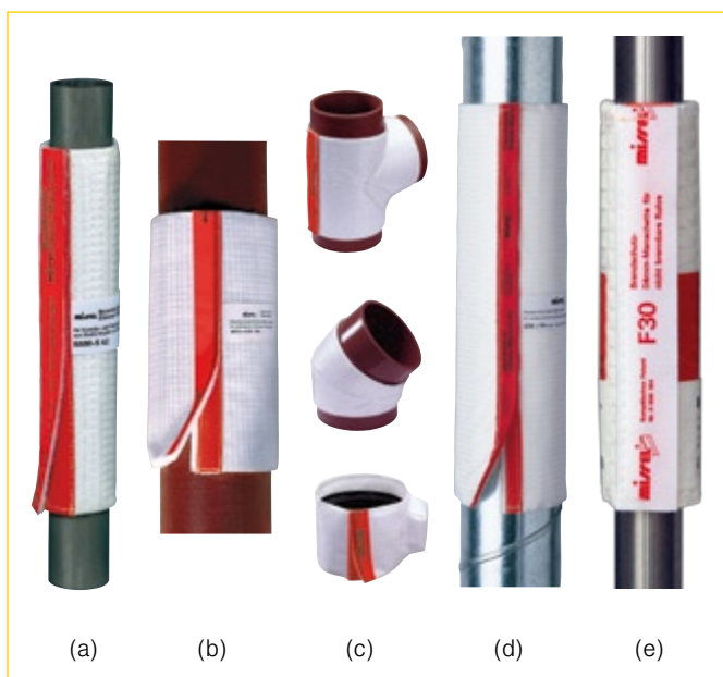
■ Bild 10 Kombinierte Brandschutz- und Körperschall-Dämm-Manschetten: (a) BSM-S für Sanitär- und Heizungsrohrleitungen, Gasleitungen, Siederohre, Feuerlöschleitungen usw. aus Stahl und Kupfer bis 160 mm Außendurchmesser und für Kunststoff- und Verbundrohre bis 32 mm Außendurchmesser; Baulängen 150 mm, 250 mm und 400 mm; (b) MSA 4-BSM für nicht brennbare Rohrleitungen aus Gusseisen und Stahl von DN 50 bis DN 150; (c) Schallschutz-Dämm-Manschetten wie Abzweige, Bogen und Verbinder; (d) BSM-L für nicht brennbare Luftleitungen NW 80 bis NW 200; (e) BSM-F30 für Rohrdurchführungen durch F30-Wände von nicht brennbaren Rohrleitungen
