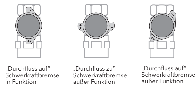
Bild 2 Die drei Funktionen der Kugelhähne (5) und (6) in der CIRCO5
