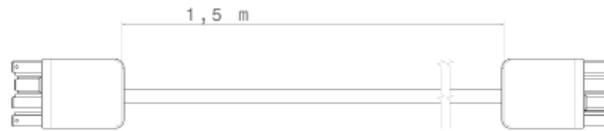
4-polige-Kabelverlängerung von 1,5 m passt auf den Anschluss am Wärmetauscher.
